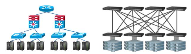
旧来の垂直トラフィック重視のネットワーク構成と、水平トラフィック重視のネットワーク構成
